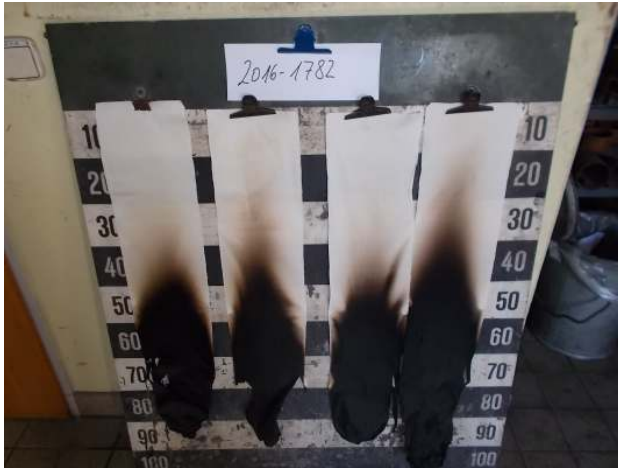
Aussehen der Probe A nach dem Brandschachtversuch
