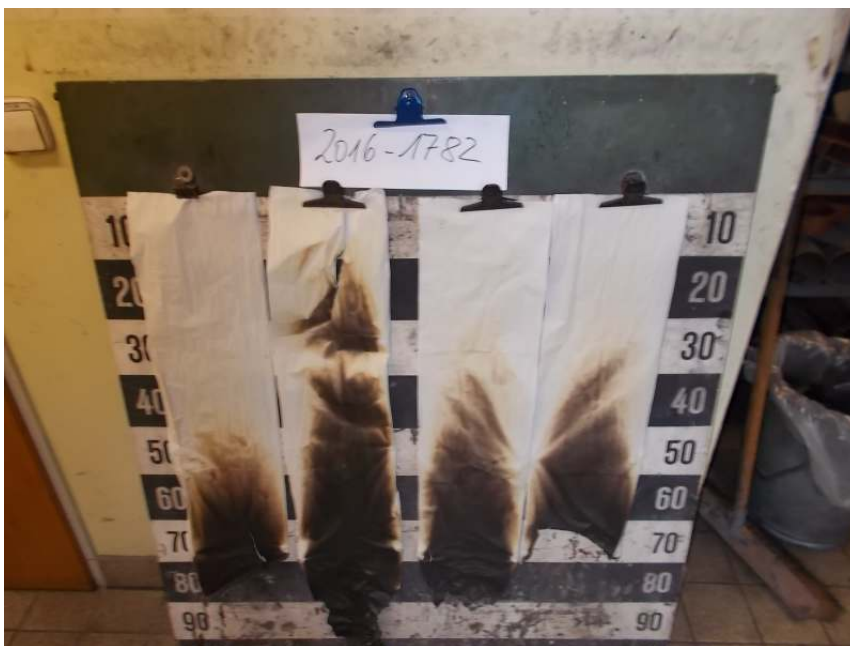
Aussehen der Probe C nach dem Brandschachtversuch
