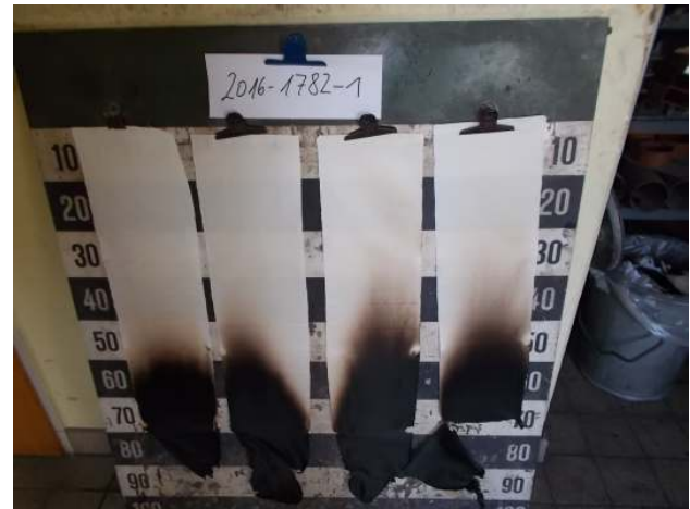
Aussehen der Probe B nach dem Brandschachtversuch
